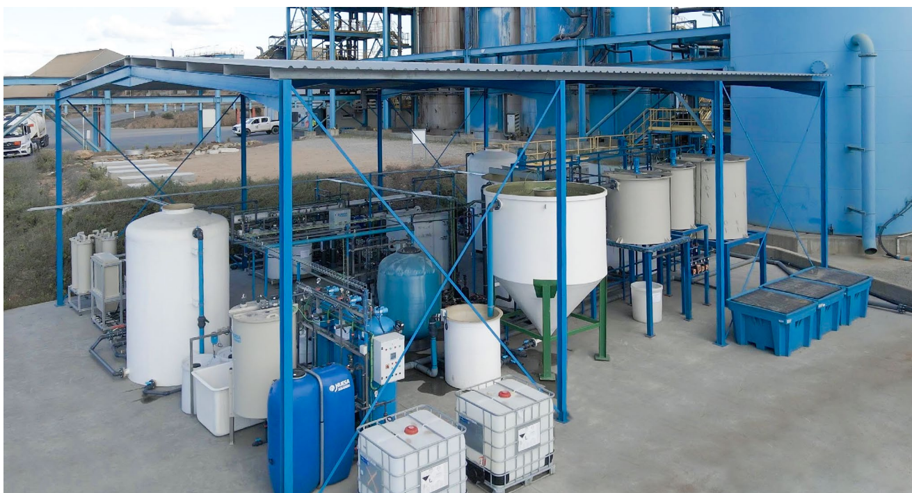
Rysunek 3. Pilotażowe instalacje uzdatniania ścieków REMINE WATER
